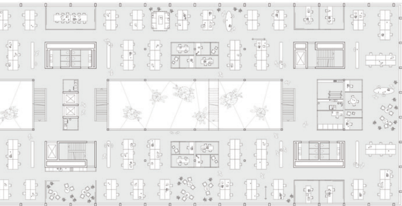
Möblierung Openspace-Büro Regelgeschoss
